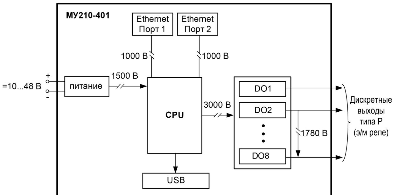
Рисунок 2.1 – Изоляция узлов прибора
