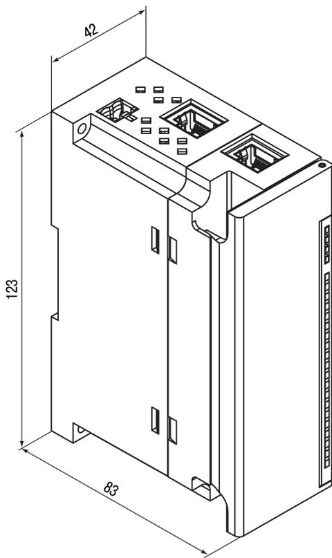
Рисунок 4.3 – Габаритный чертеж
