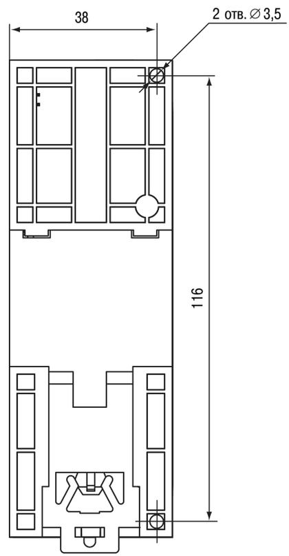
Рисунок 4.4 – Установочные размеры
